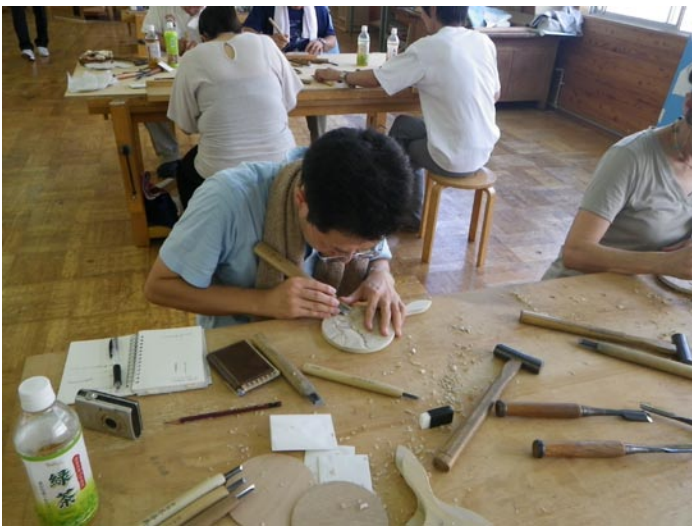
研修 1「軽井沢彫による手鏡製作」4 彫りは地の部分から彫っていく。
